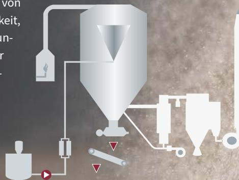
Die Sprühgranulate werden direkt nach dem Trocknungsvorgang einer Schutzsiebung unterzogen. Anschließend erfolgt die Verpackung des getrockneten Sprühgranulates in Säcke oder in vom Kunden gewünschte Spezialgebände.
